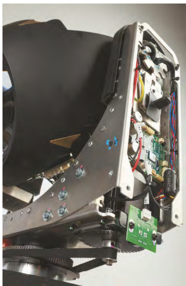
Tilt Der Kopf lässt sich tiltseitig nicht so weit hinunter führen, dass man die Tiltarretierung einführen könnte
