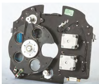
Prismamodul mit drei rotierbaren Prismen sowie einem Frostfilter
