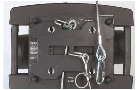
Safety-Aufnahme Nur das Kettenendglied in der Lang-Version passt genau in die vorgesehene Sicherheitsseilaufnahme, man kann das Seil aber auch unter der Camlockplatte hindurchführen
