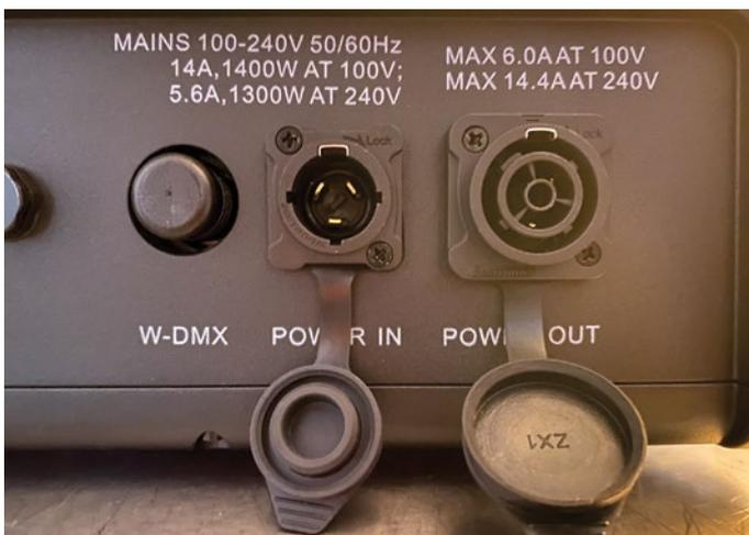
**Jetzt auch mit PowerCon True1** Weiterleitung und Stummelantenne für das W-DMX-Modul
