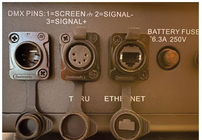
**Mit verschließbaren Gummikappen** sind die Anschlüsse ausgestattet
